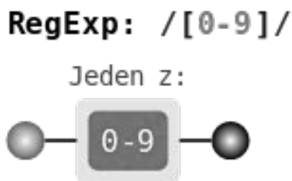
Rys. 2.4. Uproszczony schemat automatu wyrażenia regularnego akceptujący cyfrę.
