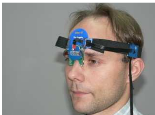
Rys. 12. Czujnik mrugnięć systemu Blink-It Źródło: http://www.ober-consulting.com/product/blink-it/
