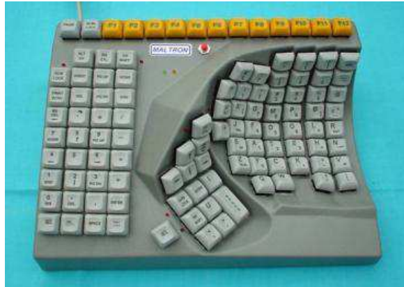
Rys. 5. Klawiatura Maltron dla praworęcznych Źródło: http://maltron.com/keyboard-info/single-hand-keyboards
