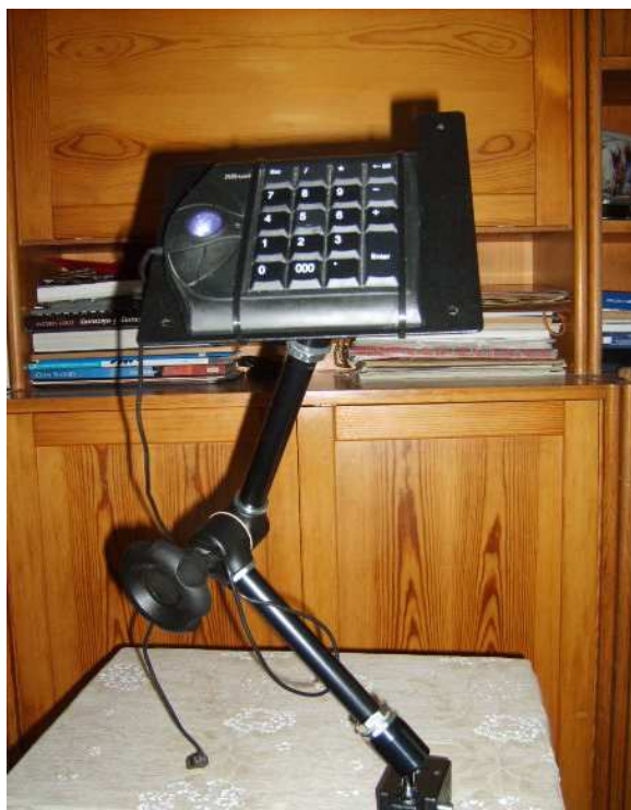
Rys. 19. Zmodyfikowana klawiatura numeryczna zamontowana na stelażu Źródło: Opracowanie własne
